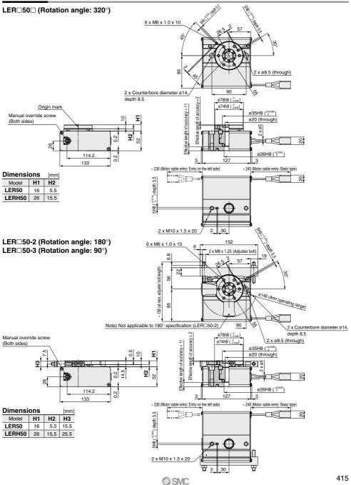
Step Motor (Servo/24 VDC)
